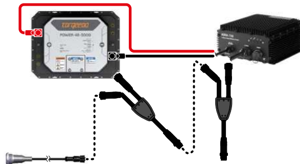
Abb. 15: Laden ohne Torqeedo Antriebssystem
